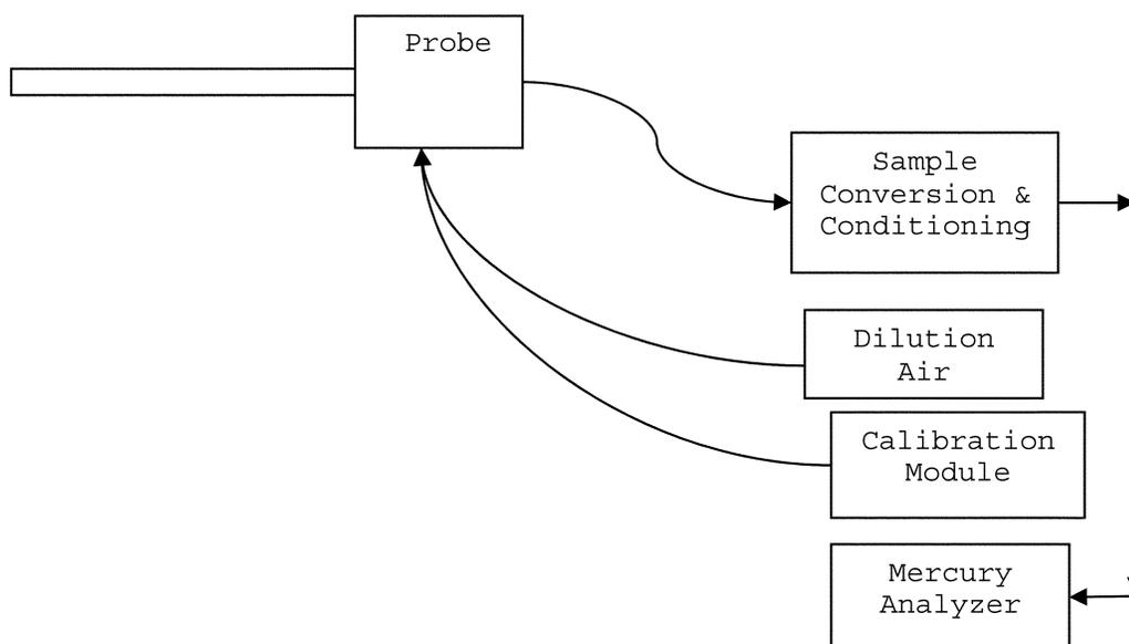
FIGURE A-1. TYPICAL MERCURY CEMS
